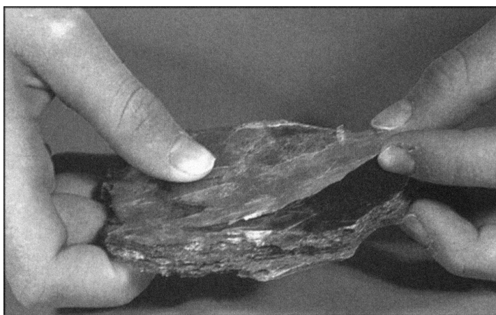
Figura 26: A mica muscovita apresenta uma clivagem perfeita, que pode ser observada na foto acima pela facilidade com que o mineral é separado em lâminas.
