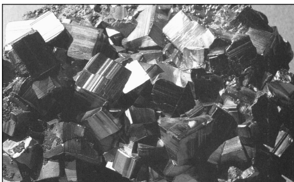
Figura 25: O mineral pirita ( \text{FeS}_2 ), também conhecido como “ouro dos tolos”, apresenta a forma característica de cubos com faces estriadas. Esta forma deriva do arranjo geométrico dos átomos que a compõem (estrutura cristalina).
