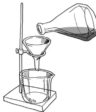
Vertendo uma mistura de um béquer sobre um funil colocado em suporte de metal sobre outro béquer.
