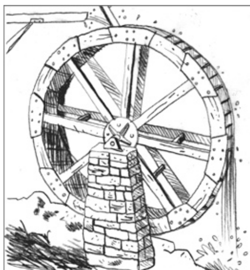
Figura 16.6: Uma catraca que através da corrente de água gera energia para moer cana.
