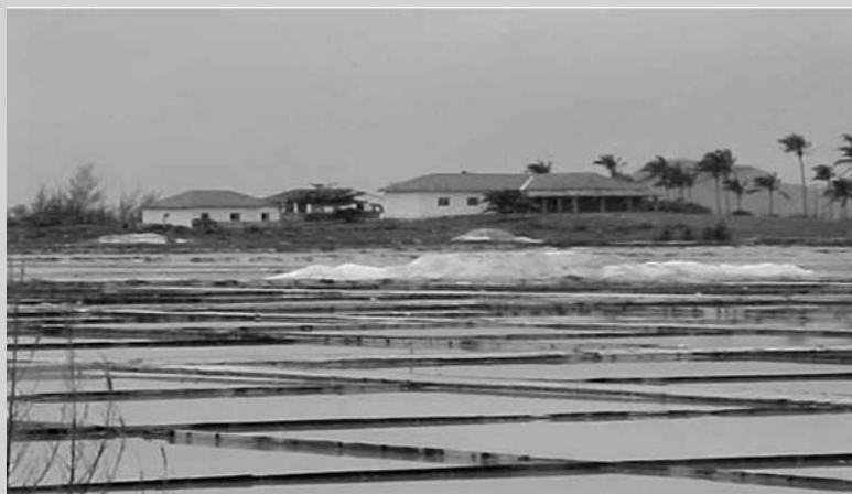
Figura 14.2: Extração de sal no litoral brasileiro, onde a água do mar é contida em reservatórios para evaporar. http://200.156.34.70/IQM/verdeII/cap2_files/fotos/salina.jpg
