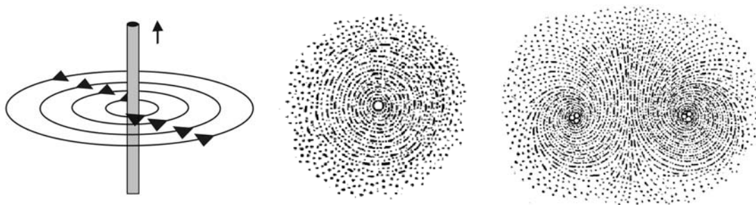
Figura 25.2.a: À esquerda, um fio condutor com uma corrente i e o respectivo campo magnético. No centro, a mesma figura anterior, porém, vista ao longo do eixo do fio. À direita, dois fios com corrente, e, conseqüentemente, a interação entre o campo magnético criado por ambos.
