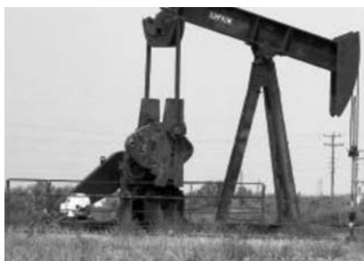
Figura 12.1: Bomba de óleo ( oil pump ) para a extração de petróleo, comum no sudoeste dos Estados Unidos.
