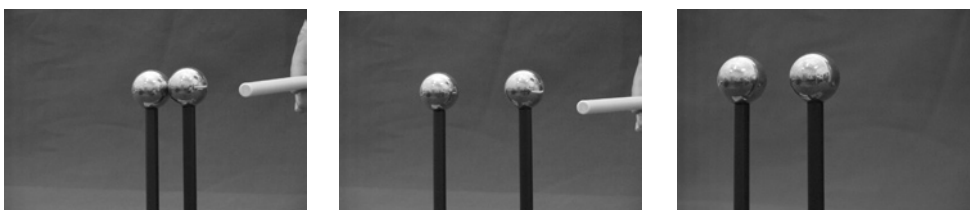
Figura 18 - Eletrização por indução.
