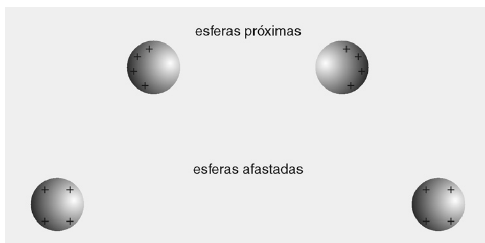
Figura 25 - Distribuição de cargas nas esferas.
