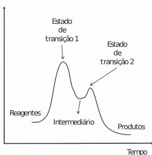
Figura 5.10 : Coordenada de reação para o mecanismo via SN_1 .
